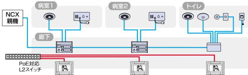
2 システム上一番遠いトイレ部分の工事をします。この時から工事終了までは、2種類のシステムが稼動する状態になります。
