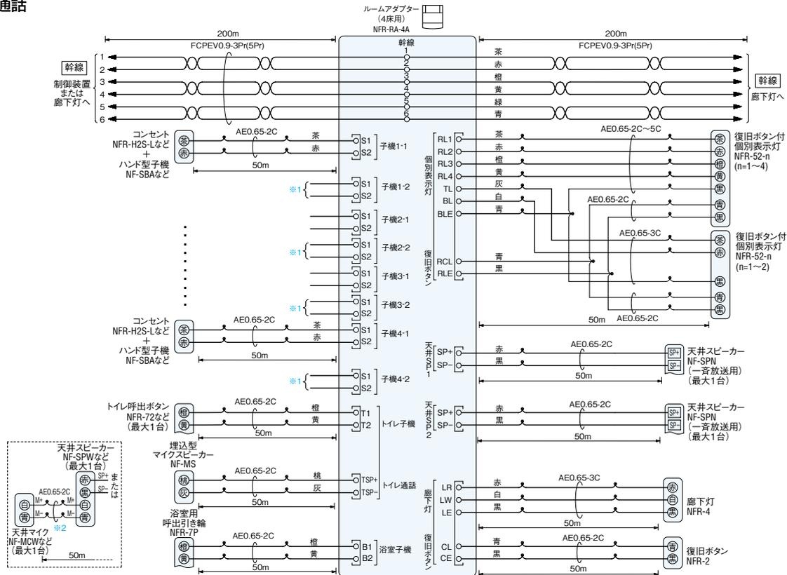
※1 1床にコンセントを2台接続できますが、使用できる子機は1台のため、子機は使用する側のコンセントへ接続する。
