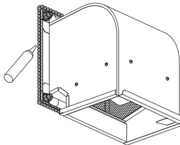
80cmサイズの場合、取付穴が16ヶ所あり、有圧換気扇共締め用穴など施工の際にご使用にならない取付穴は、コーキングまたはシーリングを行ってください。
