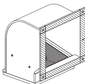
壁面取付前にウェザーカバーと斜線部にシーリングを必ず実施ください。また壁面取付後のシーリングはP10の「フランジ部分の防水処理」を参照ください。
