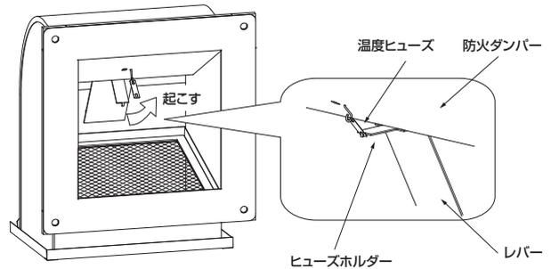
①図のように、ダンパー仮固定材を取り、温度ヒューズを仮固定しているテープを取る。
