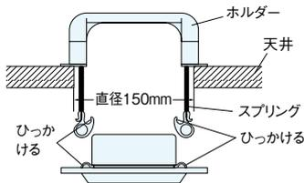
※天井スピーカーと天井マイクは1m離して設置して下さい。
