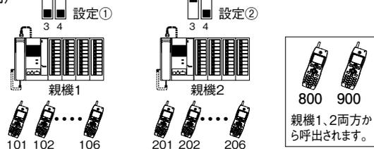
※1 PS切替システムの場合PS切替時は①に設定したハンディナースに呼出がかかります。
