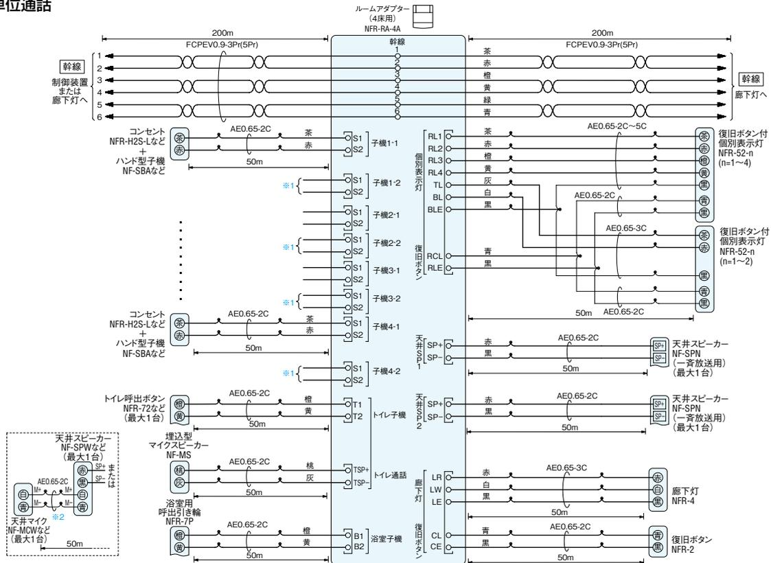
※1 1床にコンセントを2台接続できますが、使用できる子機は1台のため、子機は使用する側のコンセントへ接続すること。
