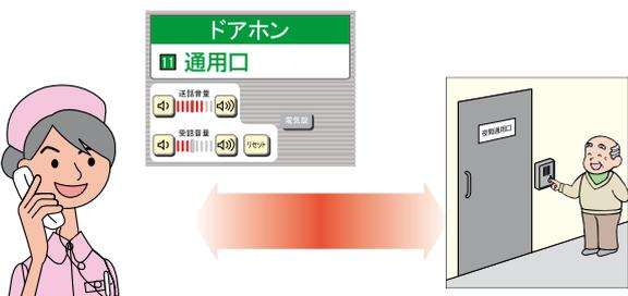
夜間通用口や徘徊病棟の出入口に電気錠を設置すれば、スタッフステーションから電気錠を解錠できます。扉を閉めれば自動的に施錠されます。親機のLCD画面では扉の開扉状態も確認する事もできます。
