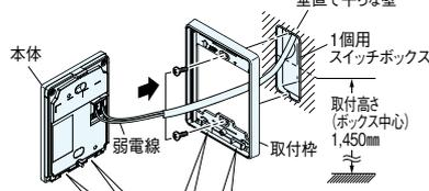
取付枠の水抜き穴をコーキング処理などでふさがないでください。
