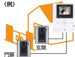
※モニター付親機では、両方の玄関子機からの呼び出しを受けます。応答設定(呼び分け)はできません。ワイレス子機は、設定により呼び分けが可能です。
