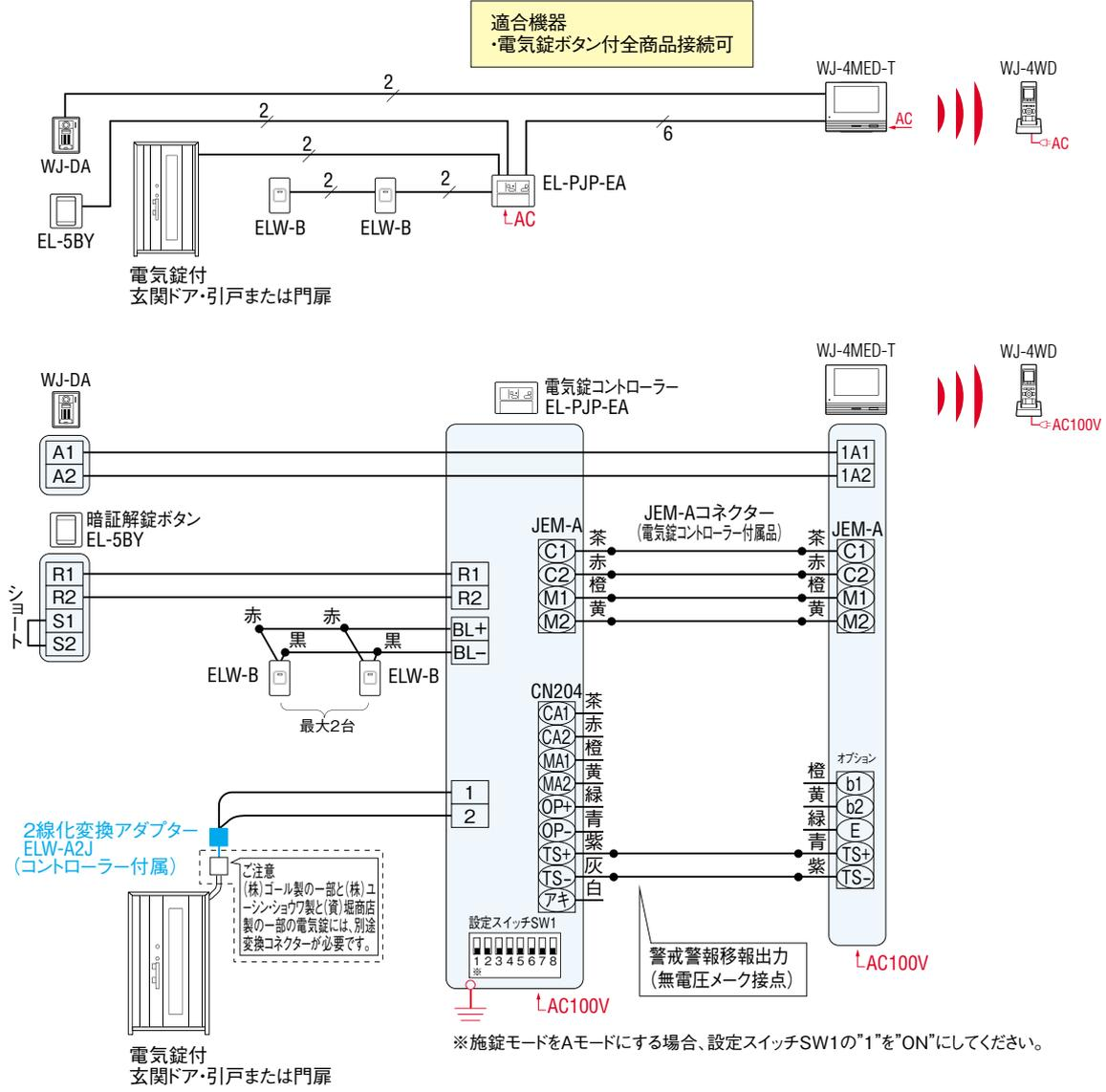
テレビドアホン配線上のご注意:インターホン系のケーブルと電気錠系のケーブルは別ケーブルとし、それぞれ10cm以上離して配線してください。
