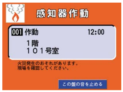
感知器作動画面 住戸で感知器が作動したとき、一体盤で感知器作動警報を行えます。
