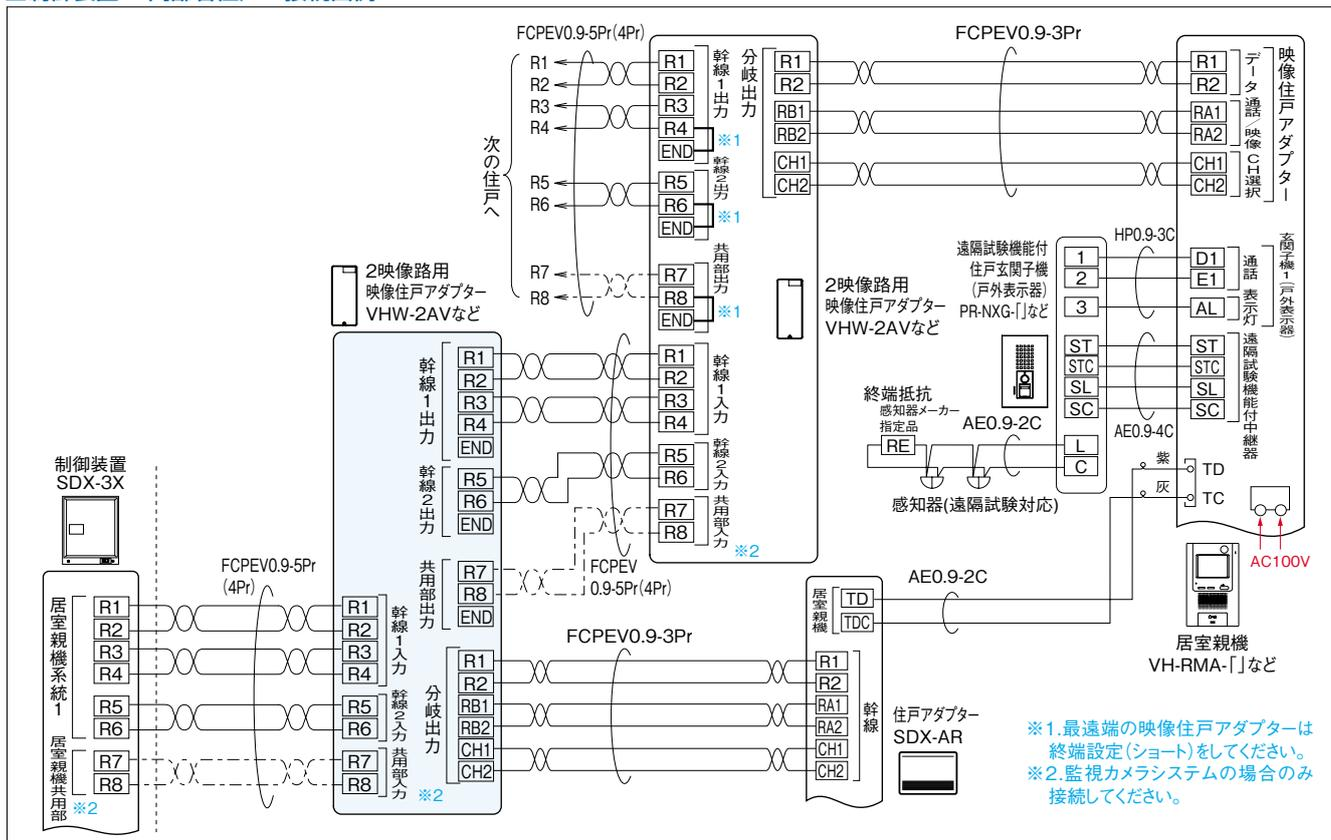
■制御装置 - 一般住戸 接続図例
