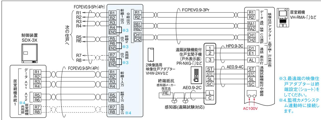
■無停電電源装置(SDX-UPS)の接続図例
