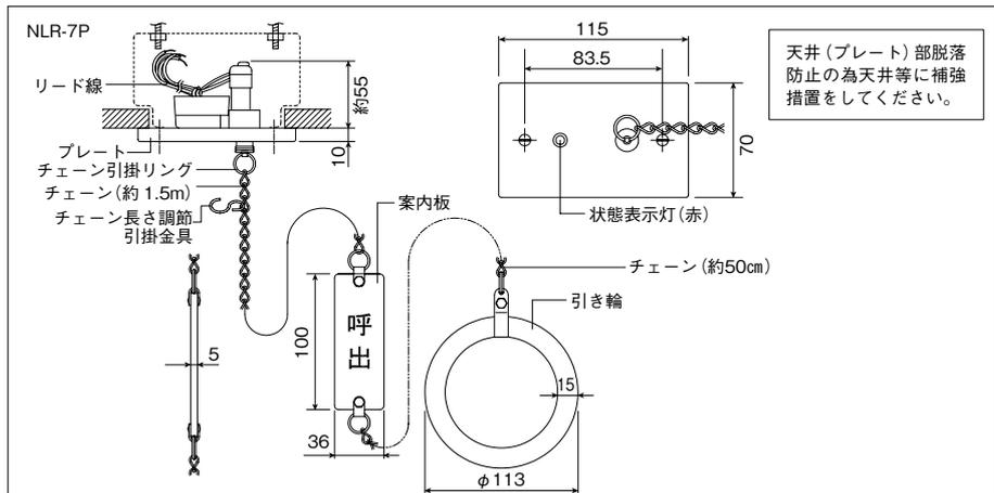
天井(プレート)部脱落防止の為に天井等に補強措置をしてください。
